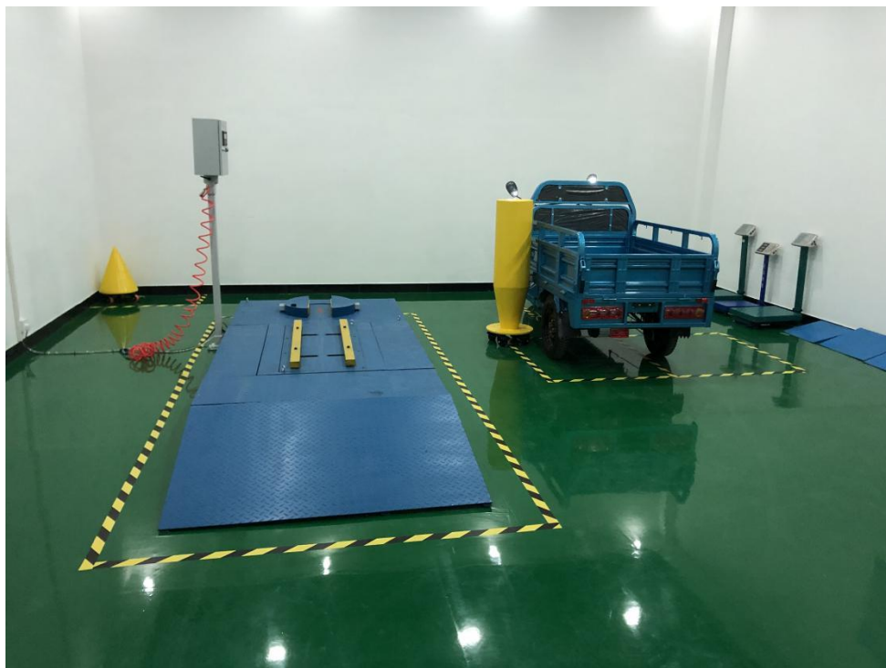
转向性能测试装置
